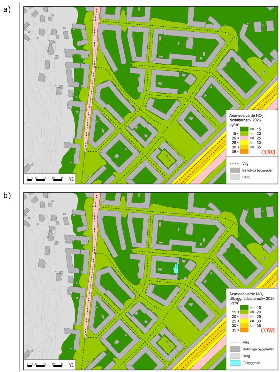
Figur 4. Beräknade årsmedelvärden av NO 2 (µg/m 3 ) för år 2026 för a) nollalternativet och b) utbyggnadsalternativet. Rosa haltgräns visar nivån för miljö kvalitetsmålet.
